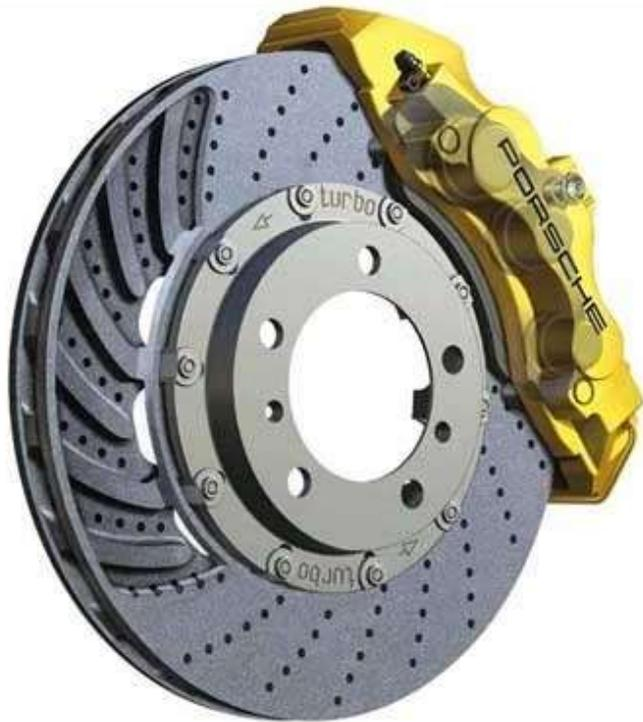
Le disque est plus léger que le tambour et ses deux faces étant en contact avec l'atmosphère, il est **mieux ventilé** et se refroidit plus facilement surtout si des **conduits internes** permettent une circulation d'air.
