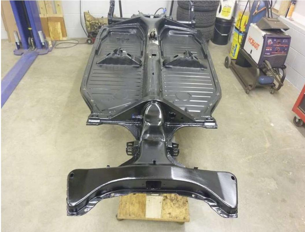
châssis à poutre centrale
