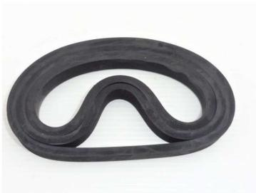
Le principe de ces anneaux en caoutchouc consistait à réunir une superposition d'anneaux de longueurs différentes qui participeront progressivement à l'effort de traction au fur et à mesure de leur allongement.
