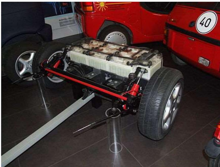
Ci dessus Accu Saft (Ni-Cd) pour véhicules PSA
