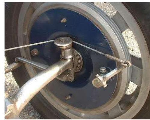
La commande par câbles, et par la suite, la transmission hydraulique ont favorisé l'installation des freins sur les **roues avant**, un montage qui s'est généralisée vers les années 1920.
