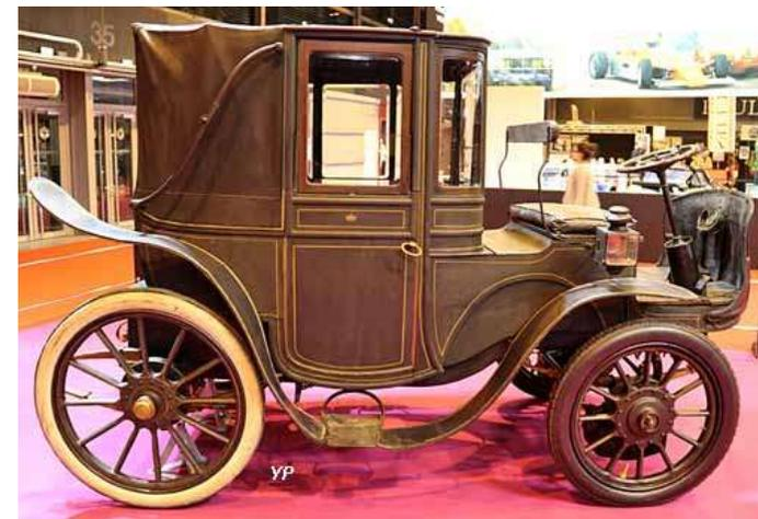
En particulier, il inventa un nouveau train avant directionnel pour remplacer les essieux à cheville ouvrière des véhicules à traction animale où l'ensemble de l'essieu pivote autour de la cheville.
