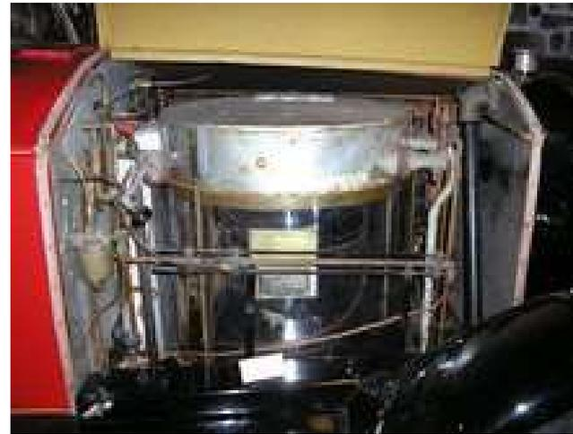
Ci dessus, la chaudière à vaporisation instantanée montée sur une Stanley de 1924.
