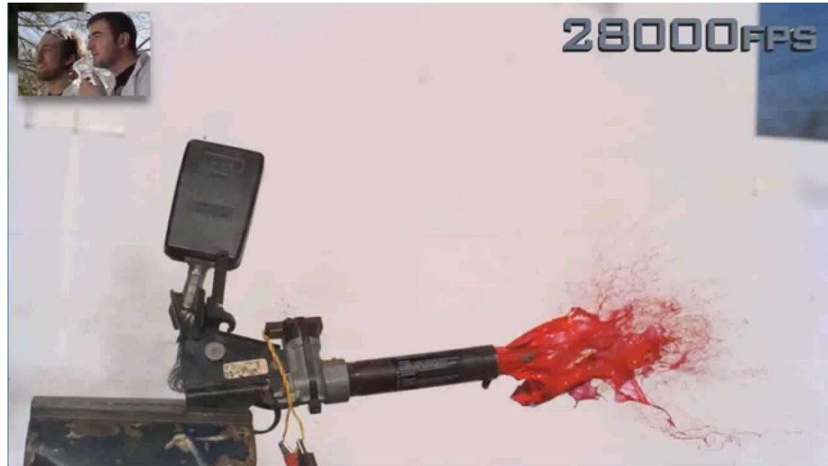
Évidemment, le prétensionneur pyrotechnique est à remplacer entièrement après l'accident.
